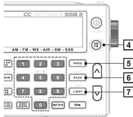
AM FM ボタンを短押しすることで、AM 放送、FM 放送の受信バンドを交互に切替えられます。SW や AIR の受信バンドから AM FM に戻るときにも、このボタンを使います。AM FM ボタンを長押しすると NOAA (米国海洋大気庁) ウェザーアラート受信機能が起動しますが、電池の消耗を防ぐ意味から NOAA ウェザーアラートの対応地域外ではオフにしておくことをお勧めします。
