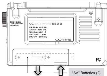
背面のバッテリーカバーは下側に押し下げると外れます。単3形アルカリ乾電池2本を＋に注意して入れて、バッテリーカバーを装着します。長期間使わないときは電池を外しておきましょう。
