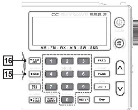
受信バンドがAM、またはSWの時に、このボタン⑮を押すとSSB受信に切り替わる準備が始まり、数秒後にこのボタンのインジケータ(赤)が点灯してSSB受信となります。SSB受信をやめるには、再度このボタンを押します。
