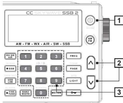
電源をオン・オフするには電源ボタン①を短く押します。スリープタイマーは、電源オフの状態ですべて電源ボタン①を長押しすることで起動します。長押し続けるとタイマー時間(120, 90, 60, 45, 30, 15, OFF)が順に表示されます。設定したいタイマー時間の時に①ボタンをはなすとスリープタイマーが設定されて電源オンになります。設定した時間が経過すると電源オフとなります。
