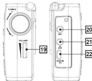
⑲を上に戻すと音量が大きく、下に戻すと小さくなります。特にイヤホンやヘッドホンを使われるときには、適切な音量調節にご注意ください。⑲は3.5mmステレオタイプのイヤホンジャックです。
